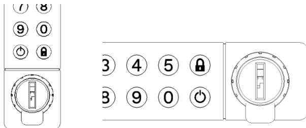
Figure 6. Manilla de la cerradura en posición cerrado (Cerradura vertical y horizontal)
